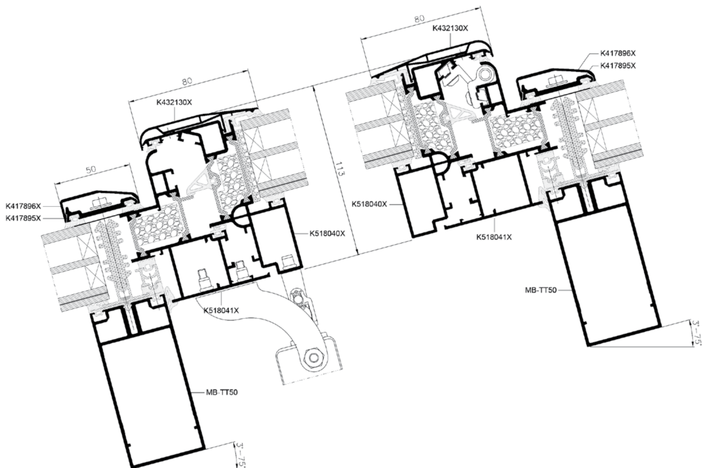
Przekrój przez okno oddymiające w systemie MB-70
